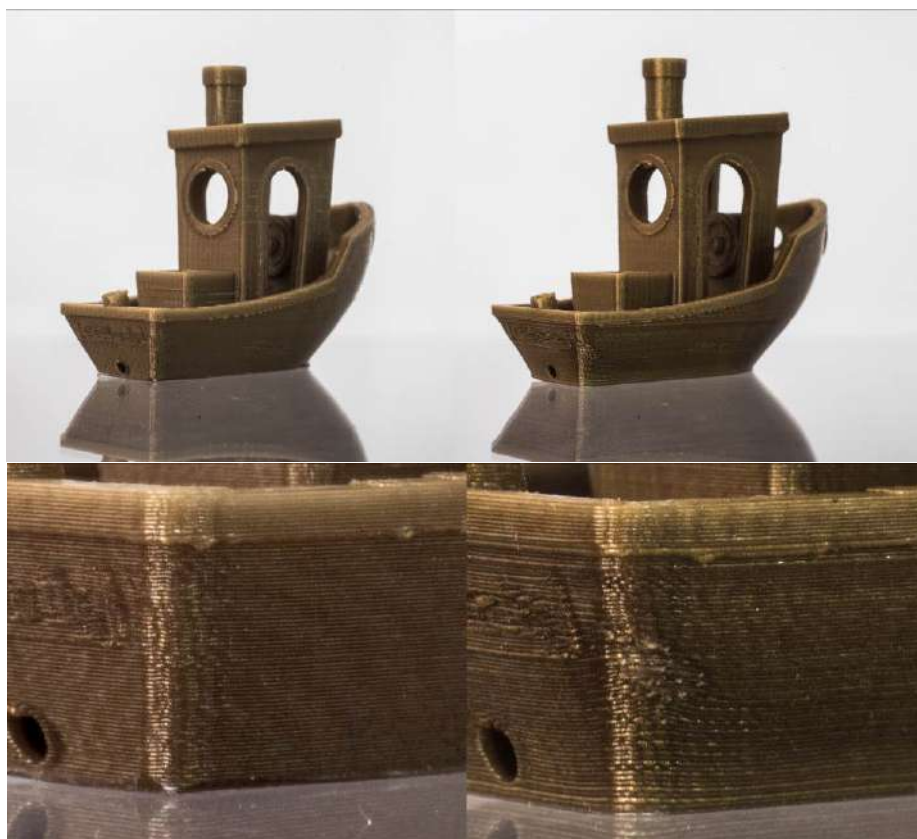
図6:PLAを使用した造形サンプルとして有名なBenchyです。左の画像は60°Cに設定された加熱ベッドで印刷されたベンチを示し、右の画像は80°Cで印刷されたベンチを示します。右側は反り、また、過度の熱により層が丸まることによる造形精度の低下も示しています。
